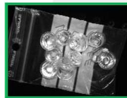
Avec un filtre polarisant sur la caméra et sur l'éclairage
